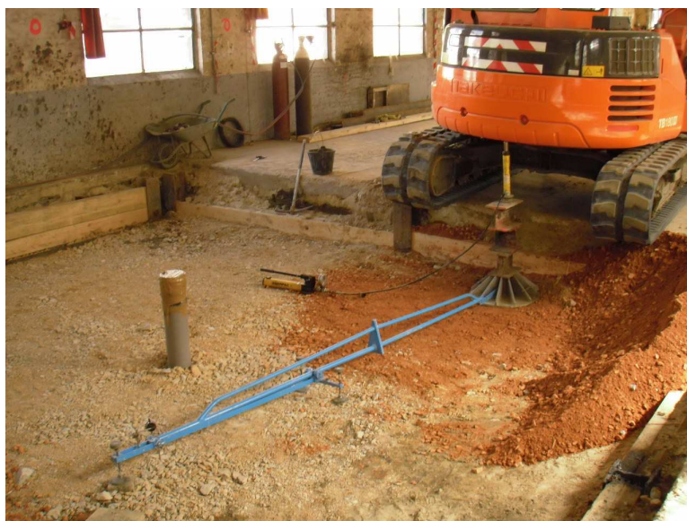
Figure 24 : Essais à la plaque à -0,6\text{m/TN}
